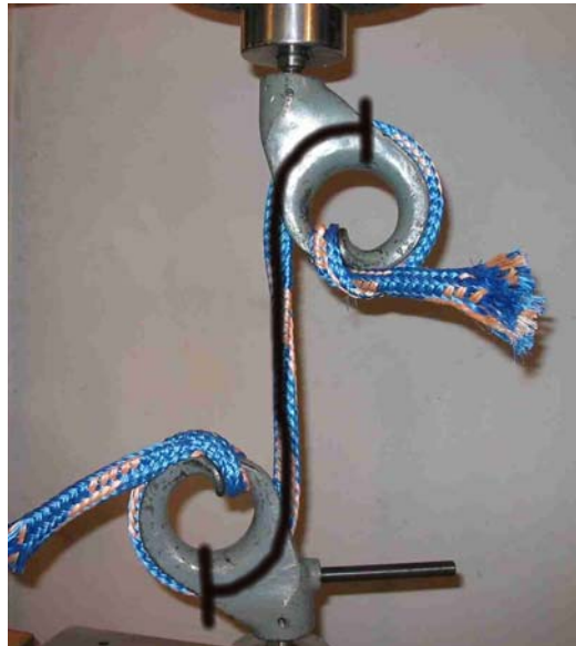
Fig. 1 Testoppsett (20 mm ”Scanflyt”)
