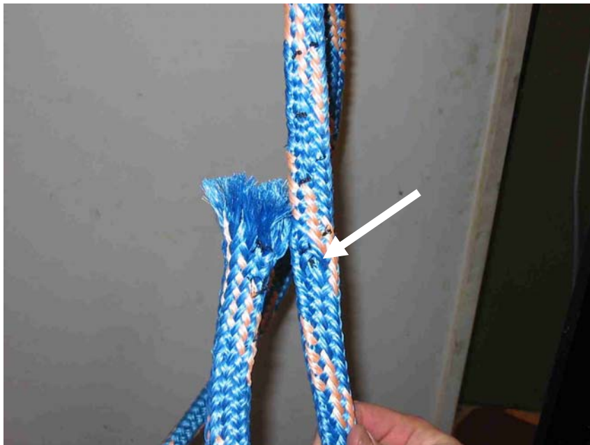
Fig. 4 Ødelagt øyespleis til 20 mm "Scanflyt". Pilen markerer innstikket.
