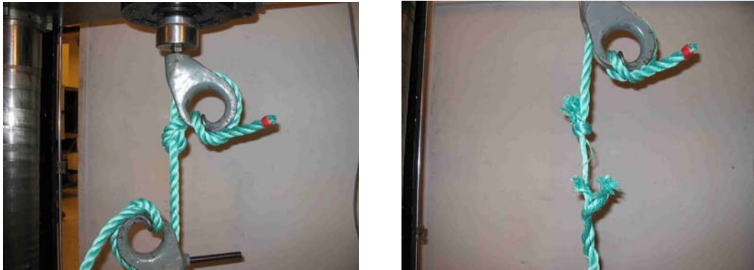
Fig. 5 Test av 18 mm flytetau med knute
